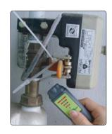
**다양한 연소, 불연소, 독성 가스를 탐지**할 수 있는 **누출탐지기**입니다. 아세톤, 알코올, 암모니아, Steam, CO (CO 농도 측정은 불가), 부탄, 가솔린, 제트연료,HS, 연기, 산업 용제, 메탄, Lacquer Thinner, Naphtha, 프로판, 천연가스 가스에 민감합니다.
